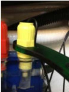
Die Messelektroden mit dem mitgelieferten Schlüssel herausschrauben und abstecken (Bajonett-Verschluss).
