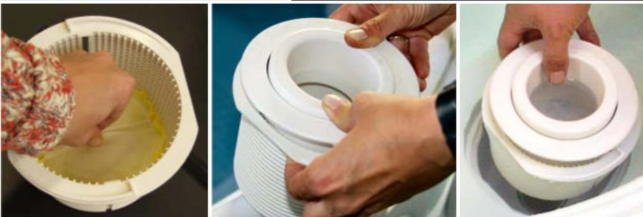
Filtermaterial zusammen mit der Klammer bis zum Boden des Skimmerkorbes drücken (die Klammer verbleibt im Korb!).
