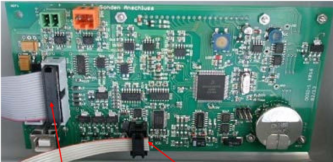
Verbindungskabel Display ↔ Leistungsplatine - **Flachbandkabel breit**
